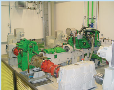
Auf dem neuen Allrad-Prüfstand bei John Deere werden die wichtigsten Arbeitsbereiche eines Traktors simuliert
