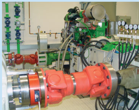
Die Anpassgetriebe setzen die Momente auf den erforderlichen Wert von 35.000 Nm an jeder Hinterachse hoch
