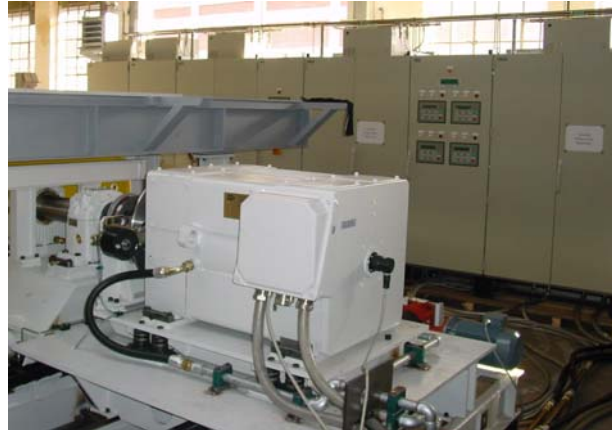
Umrichter VSI-RP für Rollen-Prüfstand, wassergekühlt
